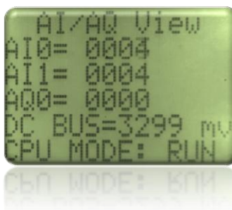
شکل (۲-۱۲): وضعیت ورودی و خروجی های آنالوگ
