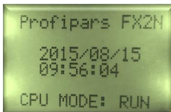
شکل (۹-۲): نمایشگر PLC در حالت Run
